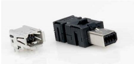
Mit nur einem Viertel der Grösse herkömmlicher RJ45-Stecker spart der Industrial Mini I/O-Steckverbinder wertvollen Platz auf der Leiterplatte. Das einzigartige Verriegelungssystem ist für eine Zugkraft von 100N ausgelegt. Die feldinstallierbare Version spart Anschlusszeit, die sonst für das Verlöten benötigt wird. Die Steckverbinder eignen sich bis zu einer Leistung von Cat6A in Industrial Ethernet Anwendungen.
