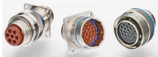
Die Stecker DL (mit Bajonettverschluss) und DBA (mit Schraubverschluss) wurden entwickelt um extremen Umweltbedingungen standzuhalten und erfüllen dabei den **MIL-DTL-83723 Series III** Standard. Die Verbinder zeichnen sich zudem durch die einfache Installation und das gewichtssparende Aluminium Gehäuse aus.
