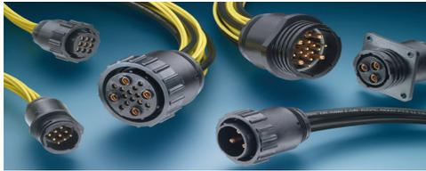
CPC Verbinder sind in sechs verschiedenen Serien verfügbar. Die Montage kann am Panel, frei hängend oder als Kabel-an-Leiterplatte erfolgen. Die Buchsen und Steckergehäuse sind für Signalkontakte, Stromkontakte oder POWERBAND-Kontakte geeignet. Diese Stecker sind für Übertragungen von Signalen und Strom im selben Gehäuse entwickelt worden. Eine IP67-Abdichtung ist erhältlich.
