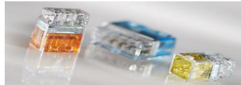
Die Push-Grip-Drahtsteckverbinder sind isolierte Spleisssteckverbinder für elektrische Installationen. Diese werkzeuglosen und leicht zu installierenden Poke-In-Verbinder eignen sich für Massiv- oder Litzen-draht der Grösse AWG 22 – 12. Die Verbinder sind zu einfachen Kennzeichnung farbkodiert und aufgrund der kompakten Grösse die perfekte Wahl für Anwendungen mit Platzeinschränkung.
