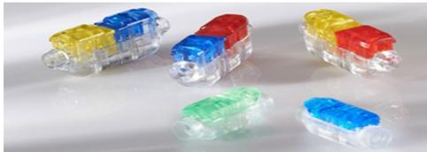
Die CoolSplice Steckverbinder sind Spleissverbindungen, die für den Anschluss von Einzeldrähten für eine Vielzahl an Innen- und Aussenbeleuchtungen, HLK-Anlagen, Gebäudesicherheissysteme und andere elektrische Installationen konzipiert sind. Die isolierten Drähte können mit einer gewöhnlichen Zange mittels Schneidklemmkontaktierung in einem Druckschalter gecrimpt werden. Die Verbinder sind als gelgefüllte und gegen Umwelteinflüsse abgedichtete Version erhältlich.
